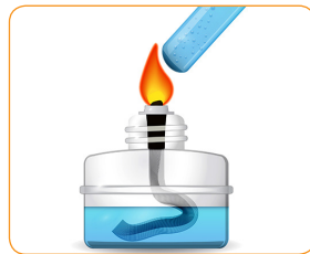
Sıvı yakıtın fitilde yükselmesi
